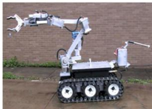
图3 “V2”防爆巡检机器人
