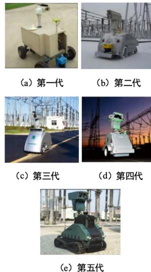
图5 五代变电站巡检机器人
