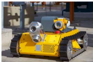
图4 履带式巡检机器人
