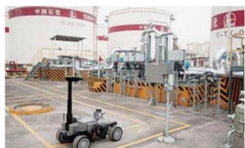
图7 轮式巡检机器人
