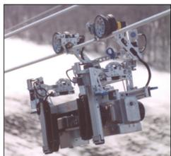
图2 “LineScout”变电站巡检机器人
