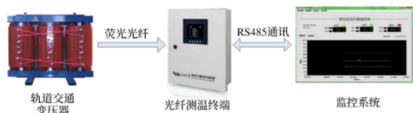
图 5 工业物联网温度实时监测系统主界面图
