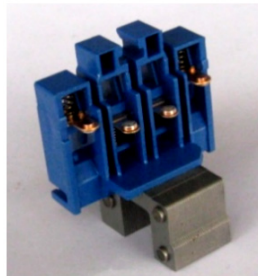
图 2 桥形触头正常情况
