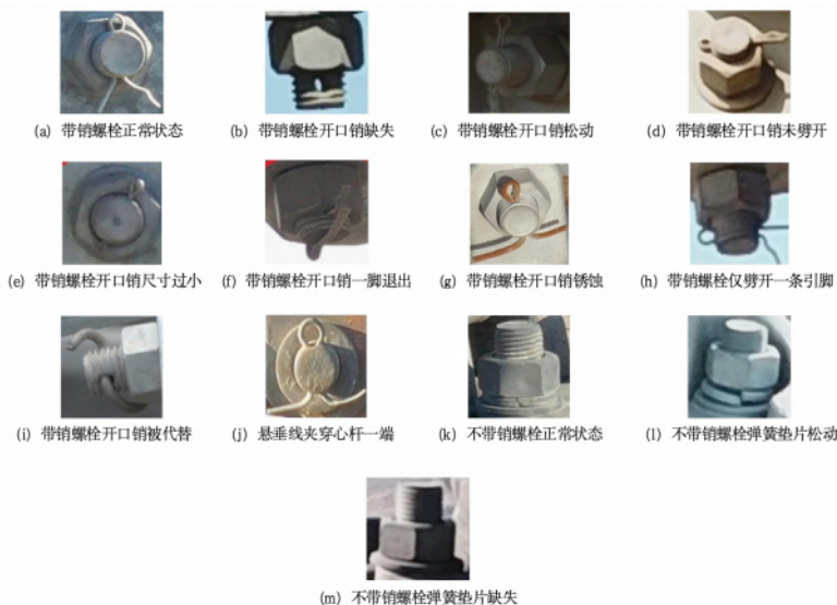
图 1 架空电力线路金具螺栓真实的存在状态
