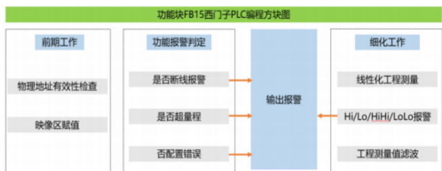
图 2 功能块 FB15 西门子 PLC 编程的方块图
