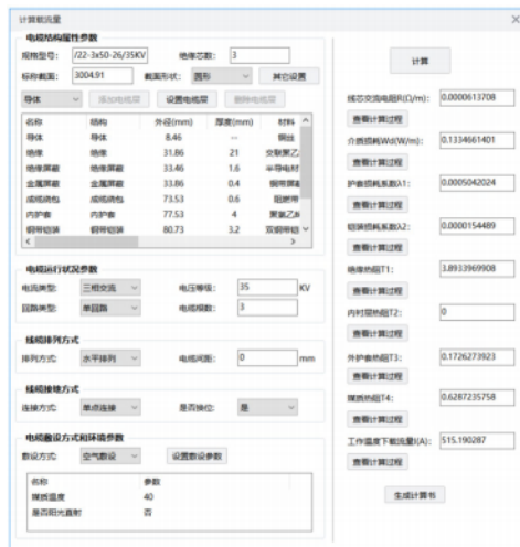
图 7 载流量计算功能模块示例
