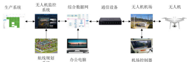
图 1 变电站无人机巡检系统结构
